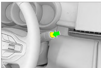
Immobilisieren und Stabilisieren des Fahrzeugs
